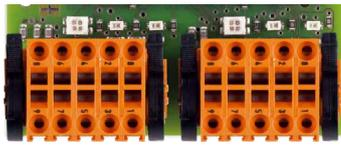
Klemme Typ K zu Port x.1 10 polig (2x5)      Klemme Typ K zu Port x.0 10 polig (2x5)
